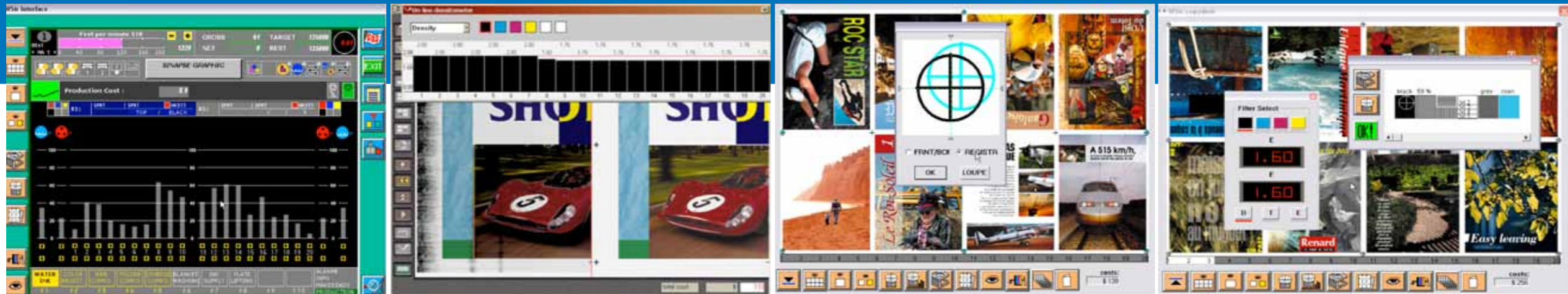
Figura 2. Ilustración de la pantalla de mando de una prensa rotativa, en este caso se ve el módulo de entintado donde el operario ajusta el color para igualar el OK de impresión.
